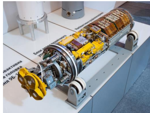
Antenne monopulse équipant l'autodirecteur d'un missile R-27 R
