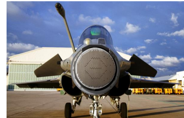
Antenne AESA du radar RBE2 (Rafale)
