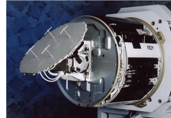
Antenne à fentes de radar RDY (2000-5)
